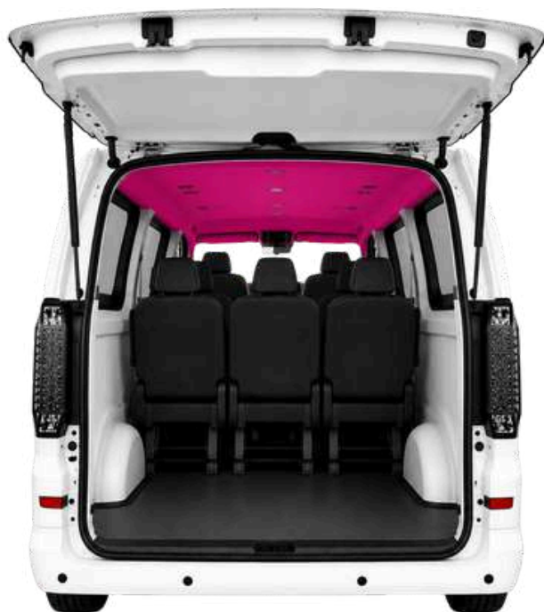
02. REVÊTEMENT DE TOIT INTÉRIEUR
